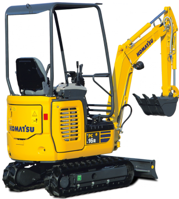
UNTERWAGEN HYDRAULISCH VERSTELLBAR von 980 auf 1 300 mm (PC16R-3HS)
